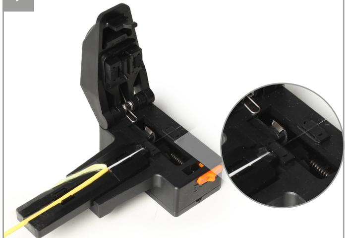
Colocar el holder con la fibra óptica en la cortadora de manera que esté alineado con el sistema de corte y asegurar que el hilo de fibra óptica quede sobre las dos almohadillas de neopreno en la base de la cortadora.
