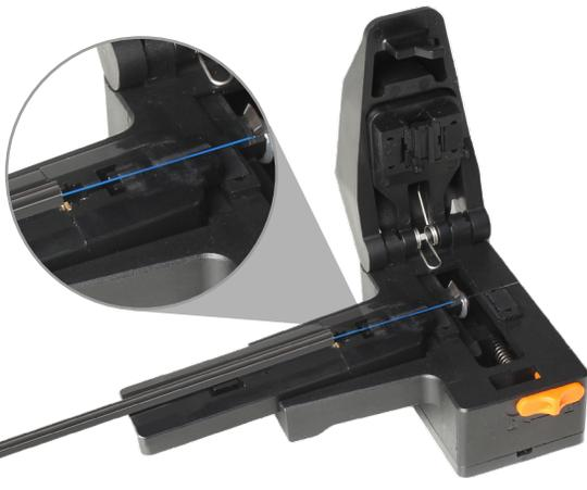
Colocar el holder con la fibra óptica en la cortadora alineándolo adecuadamente con el sistema de corte y asegurar de que el hilo de fibra óptica quede sobre las dos almohadillas de neopreno en la base de la cortadora.
