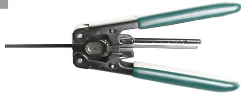
Con ayuda del pelador profesional para cable drop, marcar la longitud de cable utilizando la regleta como guía.
